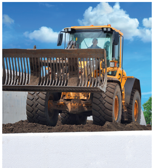
IsoBouw PowerBlok®, drukvast en dus direct belastbaar met zware machines.
