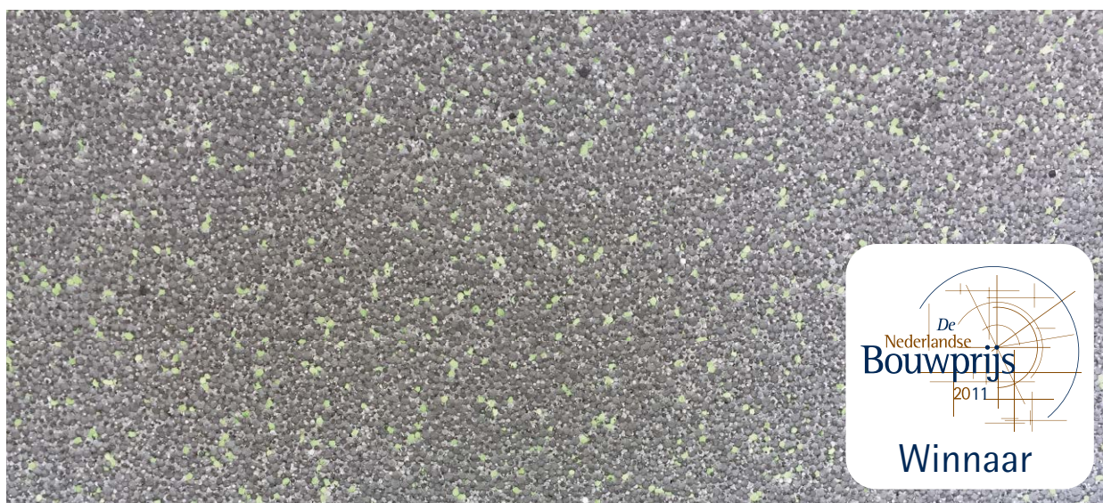
Isolatiekern: EPS HR -SE met cradle to cradle gecertificeerde BioFoam® isolatie
